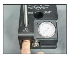
**20.** Hold handle to align pivot bolt.
