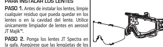
**PASO 2.** Ponga los lentes JT Spectra en la gafa. Asegúrese que las lengüetas de los lentes están colocadas correctamente dentro de la gafa, el marco externo de los lentes puede ser instalado y asegurado. Las lengüetas de Seguridad deben estar alineadas con las flechas en las clavijas para confirmar un cierre seguro. (Ver imagen F)
