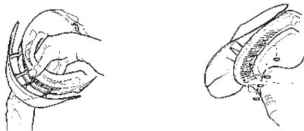
1 Insérez les supports de la visière dans les fentes d'aération sur le haut du masque. 2 Placez les joints toriques dans les encoches des supports.
