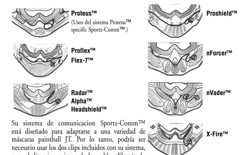
Este sistema de comunicación Sportz-Comm™ está diseñado para adaptarse a una variedad de máscaras paintball JT. Por lo tanto, podría ser necesario usar los dos clips incluidos con su sistema, para el direccionamiento de los cables. El método recomendado para organizar los cables para su máscara se muestra en una de las figuras expuestas más arriba.
