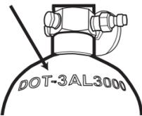
Tous les composants du système de remplissage HPA et du système de sortie du marqueur HPA doivent être adéquatement standardisés pour être utilisés avec un système de 3000 psi. Les composants comprennent mais ne sont pas limités à un dispositif d'accouplement transversal de 1/8e de pouce NPT, des tuyaux et des raccords.
