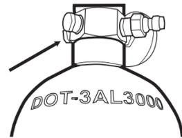
Le disque de sécurité marqué 5k est le disque de sécurité près du manchon de remplissage entrée.
